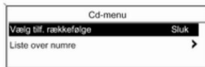
Drej multifunktionsknappen for at markere den funktion, som skal tændes eller slukkes. Tryk på multifunktionsknappen for at skifte mellem indstillingerne **Slå til** og **Sluk**.
