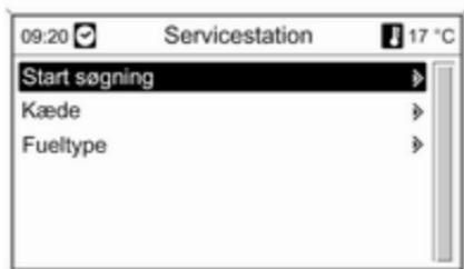
Når du har valgt **Start søgning**, starter en søgning efter alle tankstationer i området. Søgningen tager højde for alle tankstationer, som opfylder de aktuelt indstillede filterkriterier for **Kæde** og **Fueltype**, se længere nede "Indstille filtre for at indsnævre søgning".
