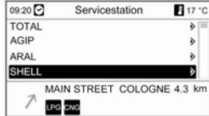
Under listeoplysninger om afstand vises den retning, der skal følges, og de tilgængelige typer brændstof (ud over benzin og diesel).
